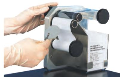
**Figura 19:** Dispensador de membranas Membrane-Butler.
